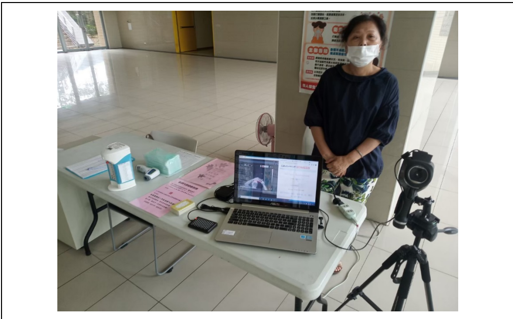
熱像儀測量體溫，便利多人行進中亦可遠距測溫、快速檢測，避免近距感染。
