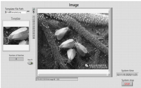
圖二: 粉蟲特徵辨識與計數監控之人機介面
